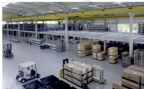
Automatisches Blocklager auf Stahlbaubühne
