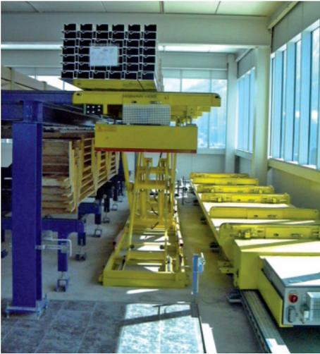
**Hubstation am Übergang vom Presswerk zum Versand**
